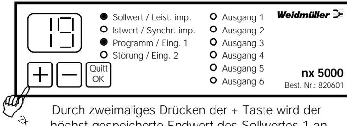
Durch zweimaliges Drücken der + Taste wird der höchst gespeicherte Endwert des Sollwertes 1 angezeigt. (Programm-LED leuchtet)
