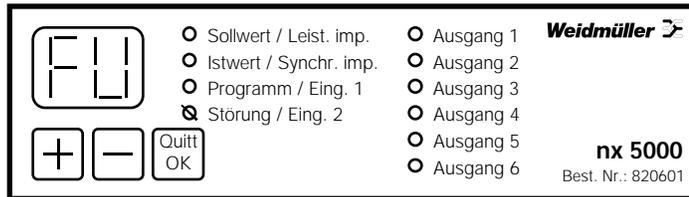
Tritt eine Systemstörung auf, wird am Display die Störungsart angezeigt und die Störungs-LED blinkt. Wurde der Ausgang 6 als Störmeldeausgang programmiert, erlischt in diesem Fall die LED „Ausgang 6“.
