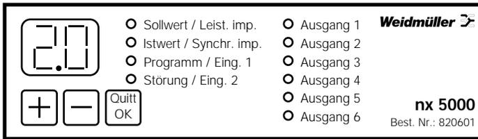
Ist die Versorgungsspannung (230 Vac) des nx 5000 ausgefallen, werden alle Verbraucher ausgeschaltet. Der 6. Ausgang gibt, wenn er als Störmeldeausgang belegt wurde, diese Störung an die externe Meldeeinrichtung (Lampe, Hupe etc.).
